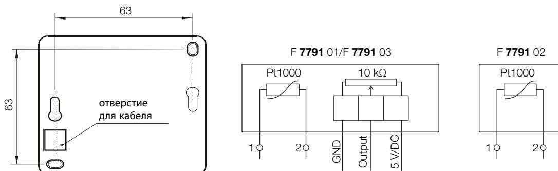
Основание корпуса датчика монтируется с помощью двух винтов диаметром 4 мм через отверстия, расположенные на тыльной части корпуса. Соединительный кабель датчика PP00 2 x 0,75 mm<sup>2</sup> и потенциометра PPY 3 x 0,75 mm<sup>2</sup>, должны быть размещены внутри корпуса через отверстие для кабеля и подключены согласно электрической схеме подключения. Датчик комнатной температуры должен быть установлен вдали от попадания прямых солнечных лучей.
