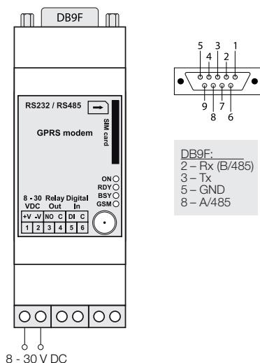
GPRS модуль устанавливается на 35мм DIN рейку.
