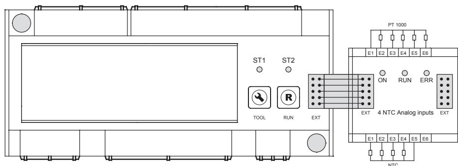
Модуль аналоговых входов устанавливается на 35мм DIN рейку.
